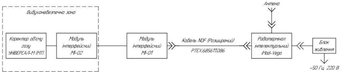
Модуль інтерфейсний MI-01 та модуль інтерфейсний MI-02 поставляються підприємством-виробником коректора УНІВЕРСАЛ-М(МТ).
