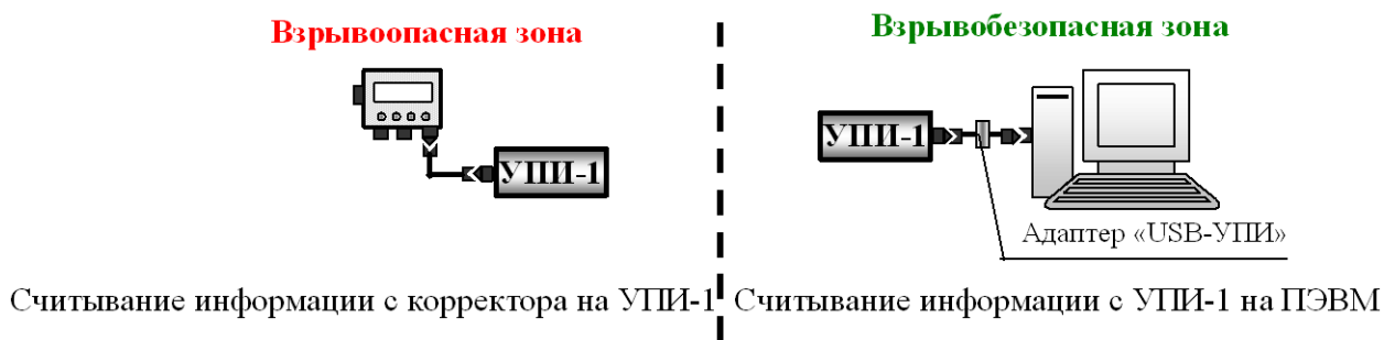
Рисунок 53 - Считывание информации с УПИ-1 на ПЭВМ через USB-порт
