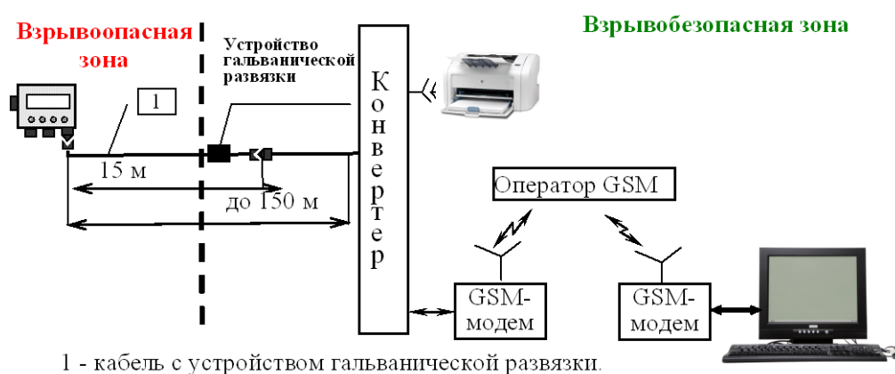
Рисунок 52 – Работа с корректором по каналу сотовой связи стандарта GSM
