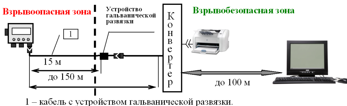
Рисунок 50 – Работа корректора непосредственно с ПЭВМ и принтером
