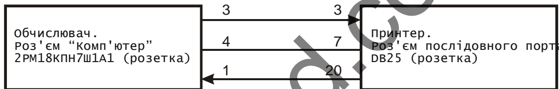
Рис. 5 Схема розпайки кабеля для з'єднання обчислювача і принтера
