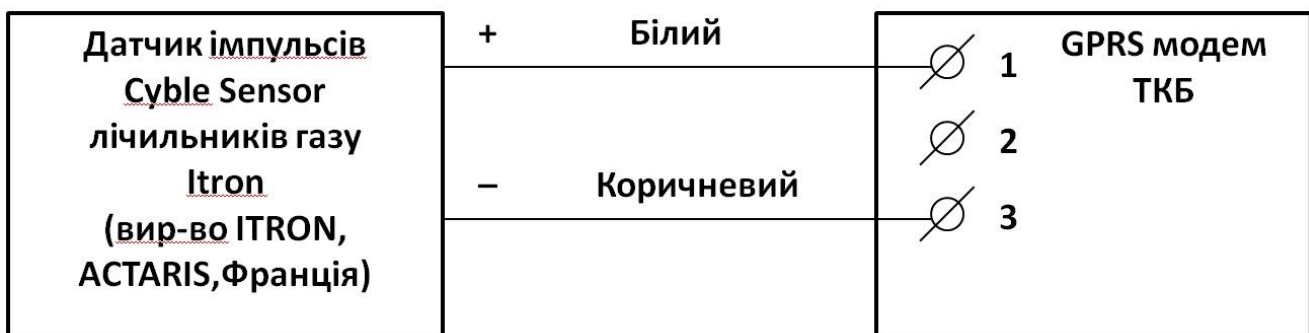
Рисунок 6 - Схема підключення датчика імпульсів Cyble Sensor лічильників Itron до GPRS модему ТКБ
