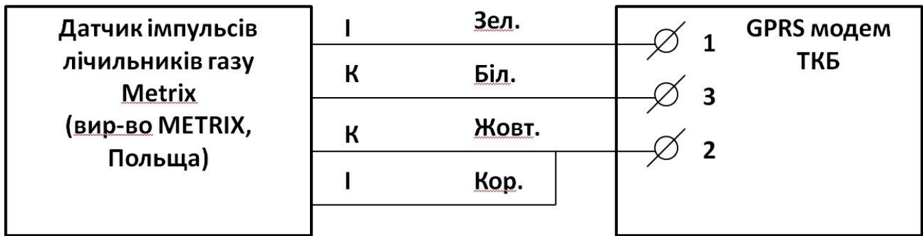
Рисунок 4 - Схема підключення датчика імпульсів лічильників Metrix до GPRS модему ТКБ
