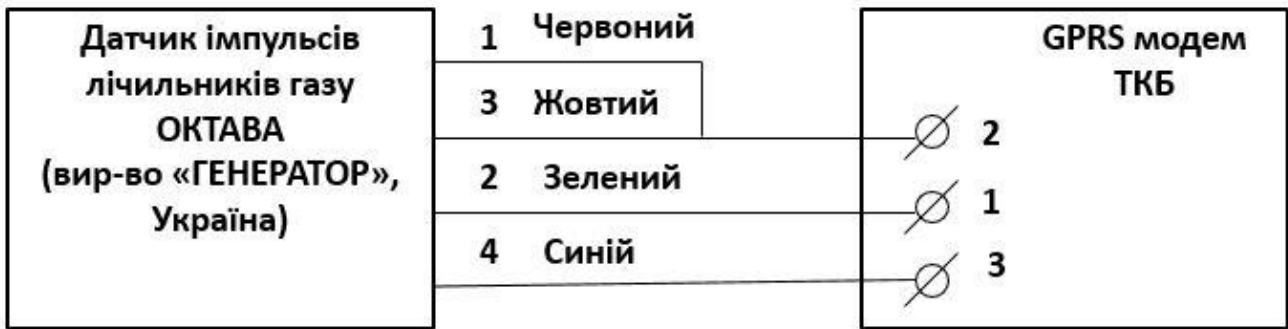
Рисунок 8 - Схема підключення датчика імпульсів лічильників ОКТАВА до GPRS модему ТКБ
