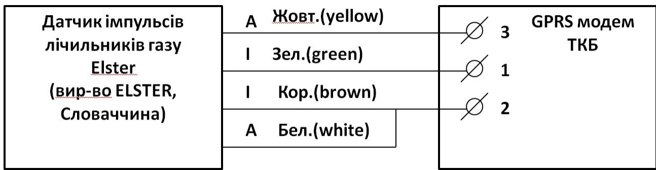
Рисунок 7 - Схема підключення датчика імпульсів лічильників Elster до GPRS модему ТКБ
