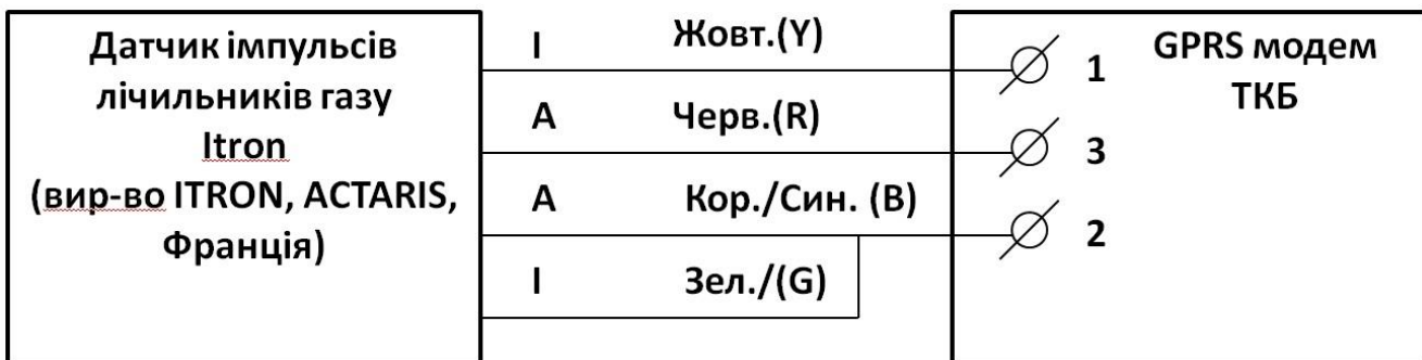
Рисунок 5 - Схема підключення датчика імпульсів лічильників Itron до GPRS модему ТКБ
