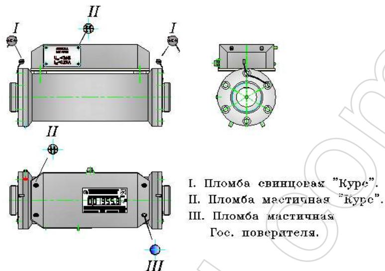
Рекомендуемая схема пломбировки счетчика
